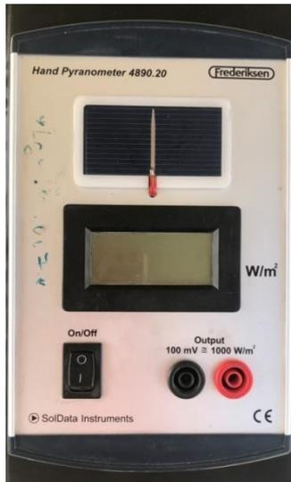
**Figure III.7 :** Pyranomètre manuel
