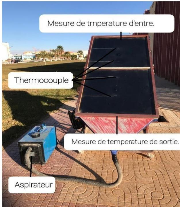
**Figure III.1 :** Banc d'essai.
