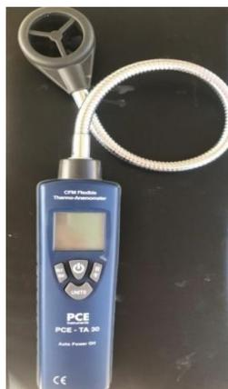
**Figure III.10 :** Thermo-anémomètre à hélice.
