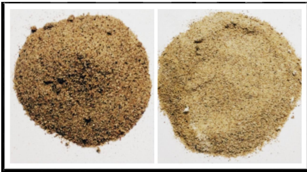
Figure I.11 : Échantillon de sable de rivière avant et après chauffage. [14]
