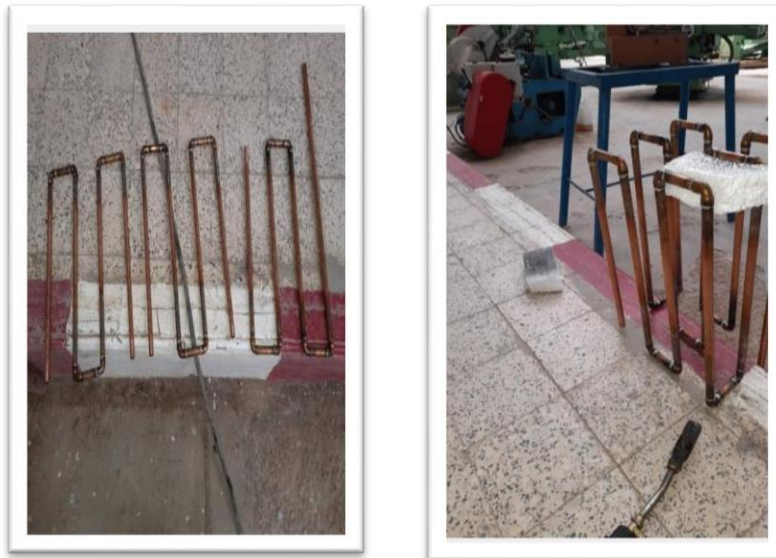
Etapes de raccordement des éléments de l'échangeur de chaleur
