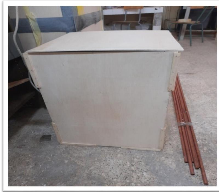
Figure (III.2) : Cuve de stockage en bois.
