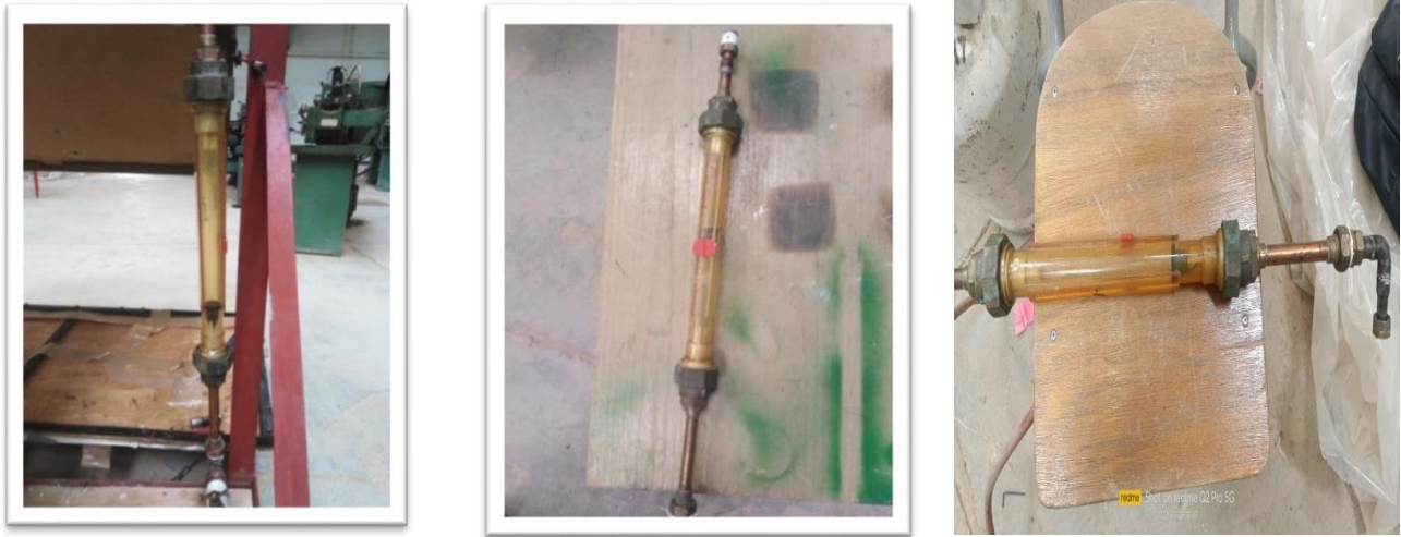
Figure (III.14) : Débit mètre à flotteur gradué de 0 à 160 l/h.
