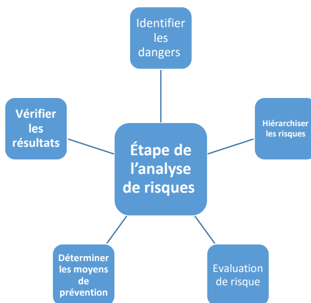
Figure II.1 : Étape de l'analyse de risques [14]
