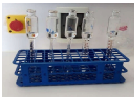
Figure 07 : Butyromètre GERBER contenant les 10 ml Acide sulfurique ( H_2SO_4 )
