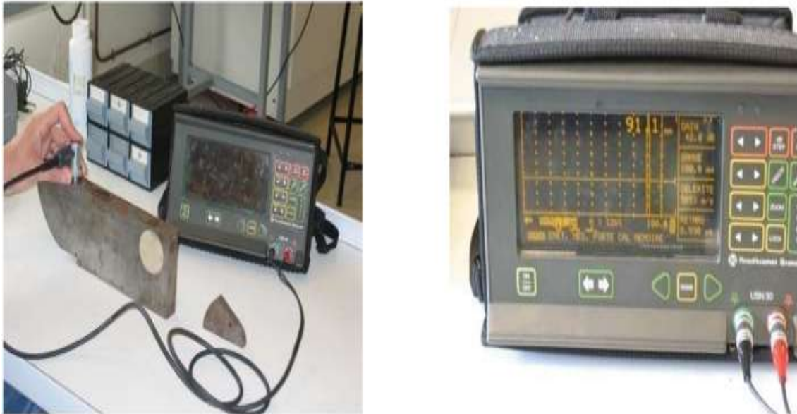
Figure II.10 : Mesure d'une fissure interne par ultrasons
