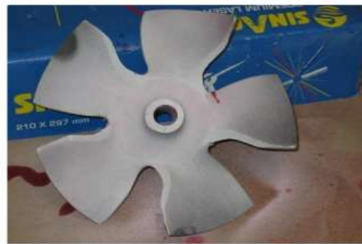
d – Apparition d'une fissure
