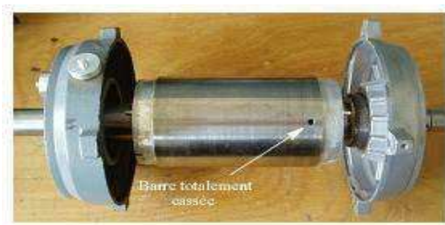
Figure I.13 : Photo d'une barre cassée
