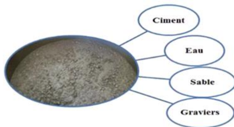
Figure I-1 : Constituants d'un béton ordinaire [12]
