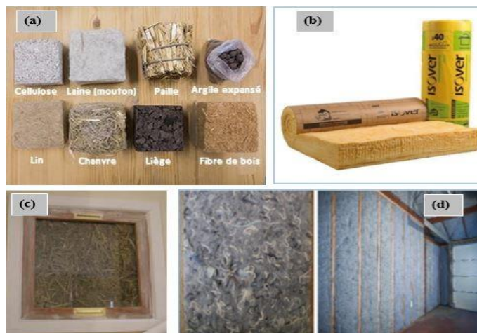
Figure I.10 : (a) :Liste de quelques isolants conventionnels ; (b) :Laine de verre (isolant conventionnel); (c) : Balle de paille (isolant non conventionnel) ; (d) : Panneau de réalisé à partir de Cotton recyclé (isolant non conventionnel).[14]
