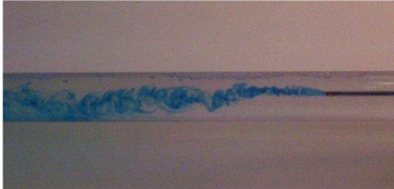
Figure 12 : Expérience de Reynolds, l'écoulement turbulent. [13]
