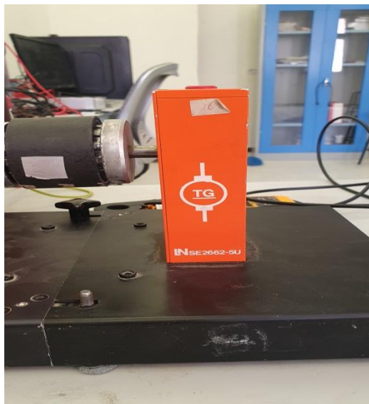
Annexe A2 : Tachogénératrice (capteur de vitesse) et voltmètre.
