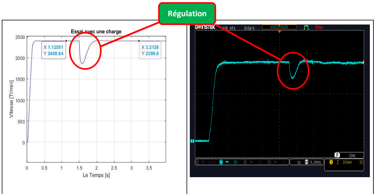
Fig II.66. Vitesse De Rotation avec une charge boucle fermé ( N_{ref} = 2400 \text{ Tr/min} , C_r=2.5 \text{ Nm} )
