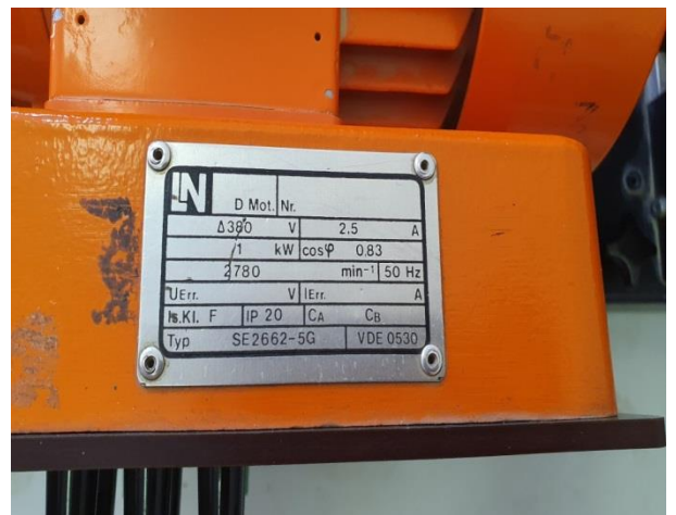
Le Moteur Asynchrone avec la plaque signalétique
