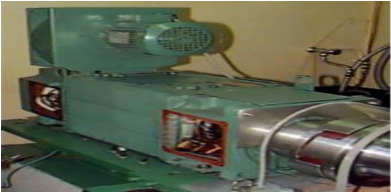
Fig. I. 19: moteur à courant continu de 47 kW à 3100 tr/min (Leroy Somer)
