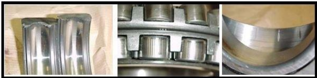
Figure I.13: dégradation d'un roulement [16]
