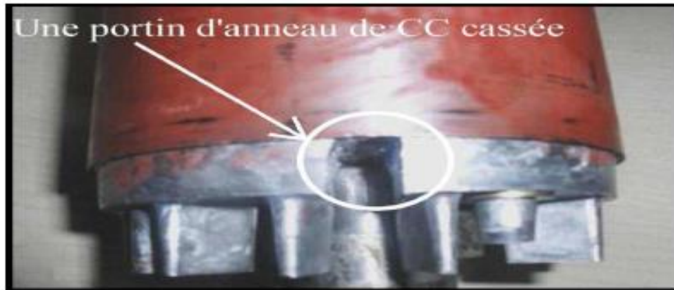
Figure I.20 : Rupture d'une portion d'anneau de court-circuit [20]
