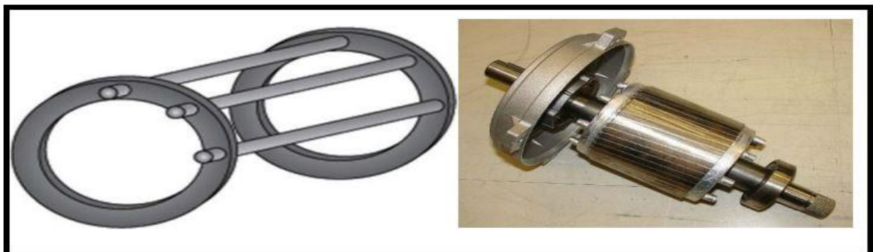
Figure I.3: Structure d'un Rotor en cage d'écureuil. [5]
