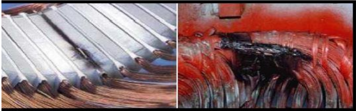
Figure I.16 : Exemples de dégâts dus au défaut de court-circuit statorique d'un moteur asynchrone [17]
