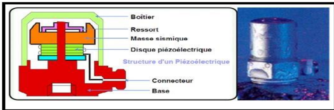
Figure II.13. Schéma de principe d'un accéléromètre [51]
