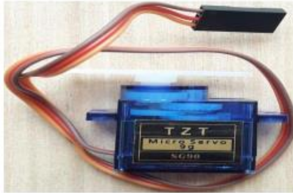
Figure III.5 : Modèle d'un servomoteur.
