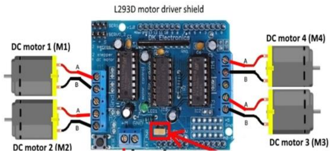
Figure III.17 : Comment connecter les moteurs à courant continu à L293D
