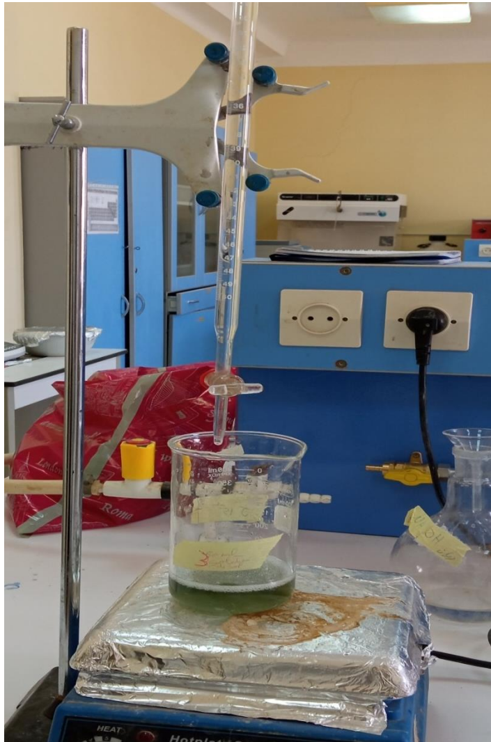
Figure 28 : dosage le Mg de vinaigre par la titration
