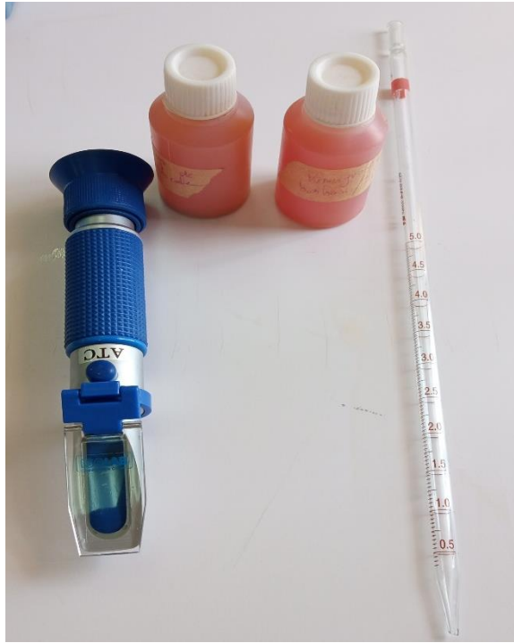
Figure 30 : Mesurer sucres totaux de vinaigre avec un réfractomètre
