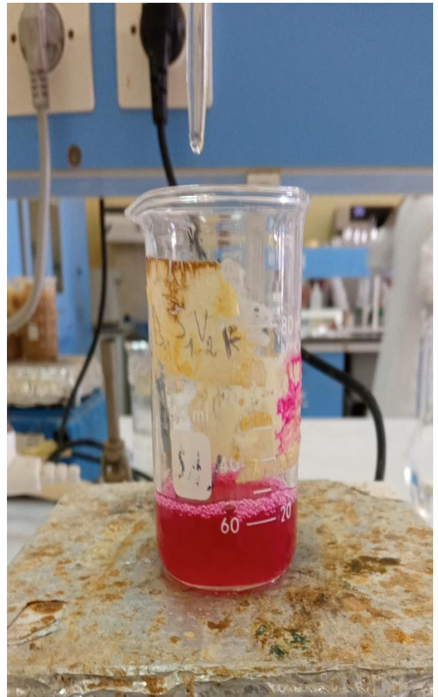
Figure 29: Détermination de la teneur en acidité totale de vinaigre par la titration
