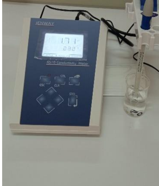
Figure 35: détermination le CE de l'eau d'irrigation par la conductivité mètre
