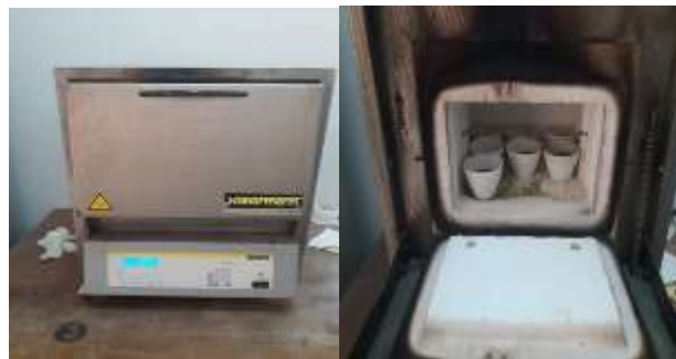
Photo 26: méthode voie sec calcination (photo original).
