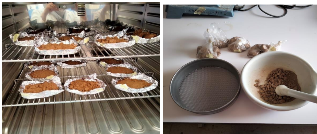
Photo 6 : séchage, broyage et tamisage du sol (Photo originale 2022).
