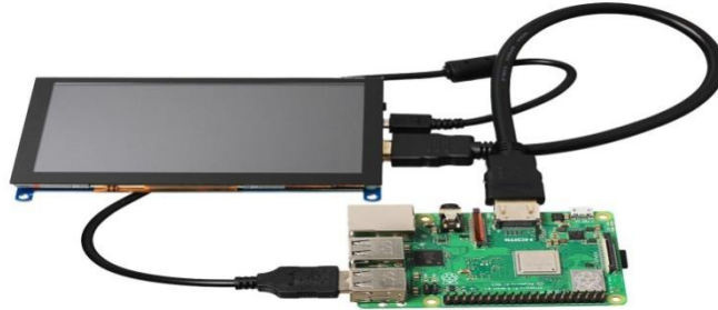
Figure 3.4 : Afficher le contenu de Raspberry pi avec écran utilisant un câble HDMI.
