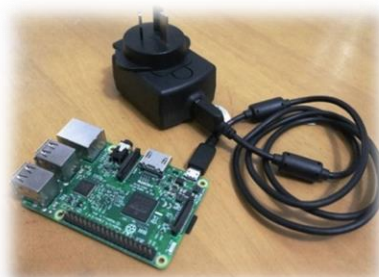
Figure 3.3 : Alimenter Raspberry Pi pour démarrer l'os.
