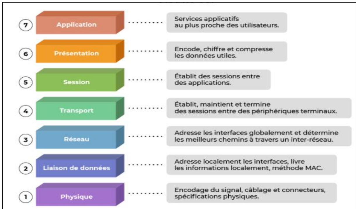
Figure I.19 : Les différentes règles de communication d'un réseau en 7 couches d'OSI [20]
