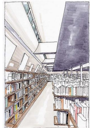
Figure 52 : Exemple d'une fenêtre à claire-voie élevée dans un mur extérieur, avec une surface rétro-réfléchissante pour fournir de la lumière sur les surfaces verticales des piles au niveau du mur. (Bibliothèque publique de Wolfsburg, Wolfsburg, Allemagne), ( Source : PDF:Daylightin design in libraries .p 10)
