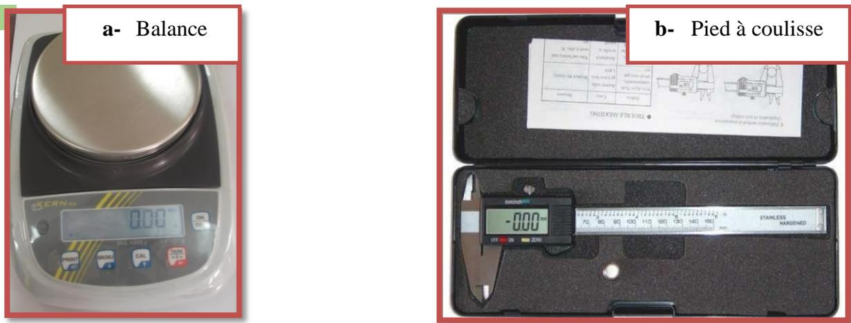
**Figure 8** instruments utilisé (a et b)
