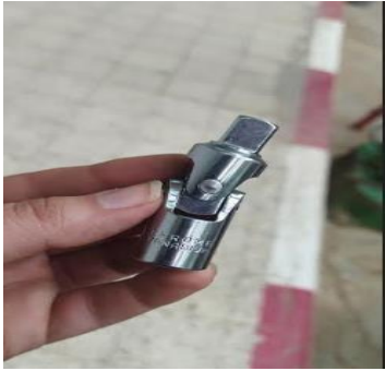
Figure 3. 17 : joint universel leurjeux de barre
