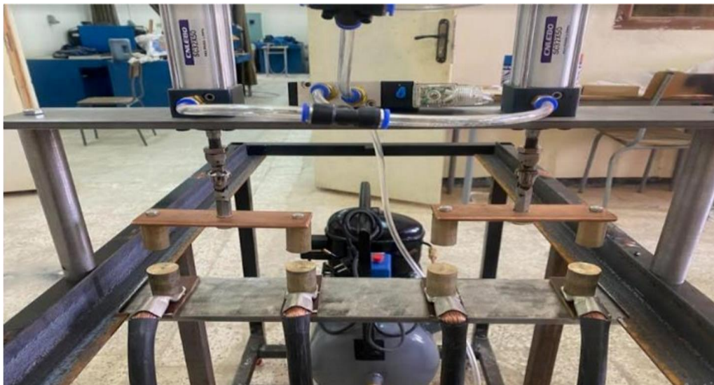
Figure 3.19 : les bouts de soudage alimenté par transformateur
