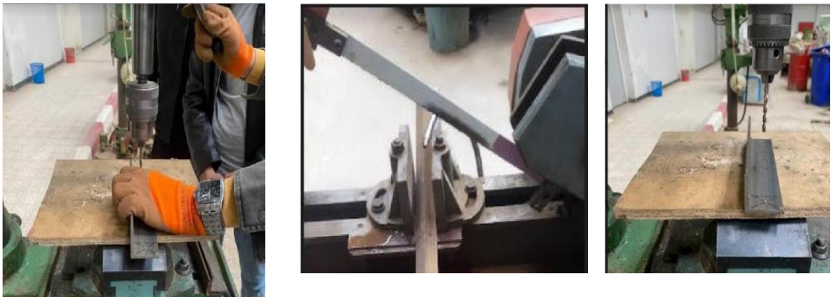
Figure 3.6 : coupure et ajustement du cornière
