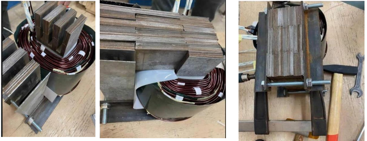
Figure 3. 10: emplacement de bobinage primaire sur le circuit magnétique
