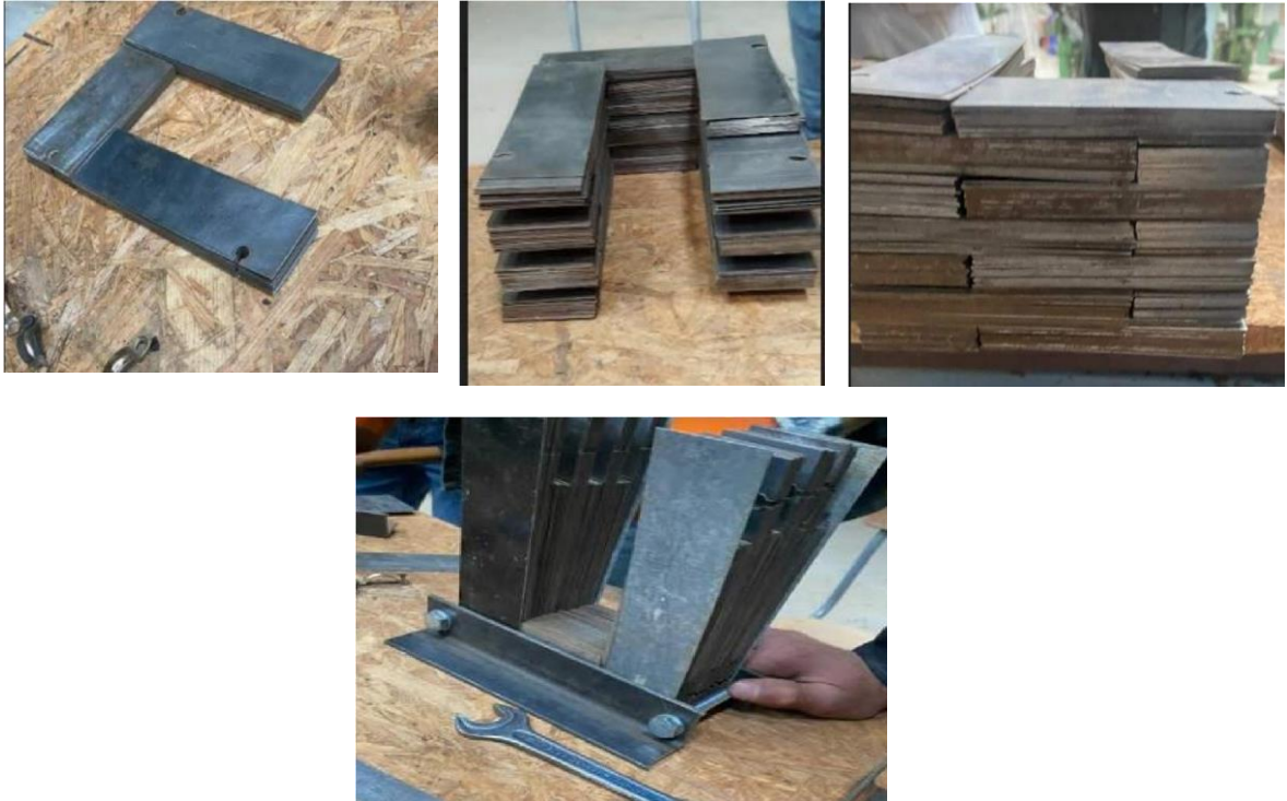
Figure 3.7 : reconstruction de circuit magnétique
