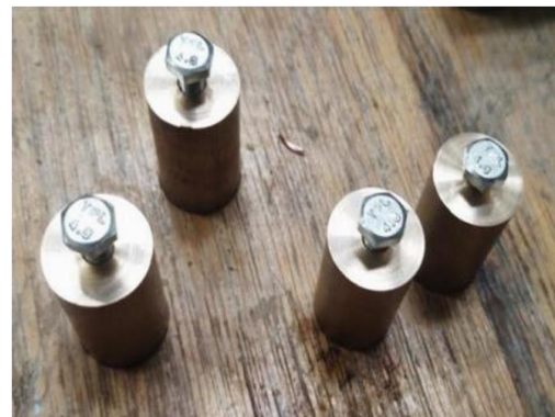
Figure 3.16 : cuivre coupé des cathodes et du support et le jeu de barres
