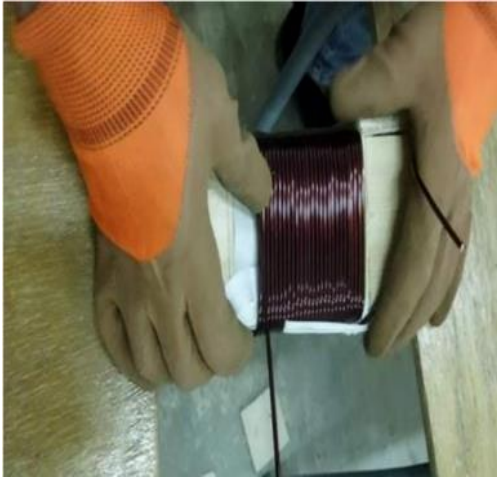
Figure 3.8 : bobinage du nouveau circuit primairee
