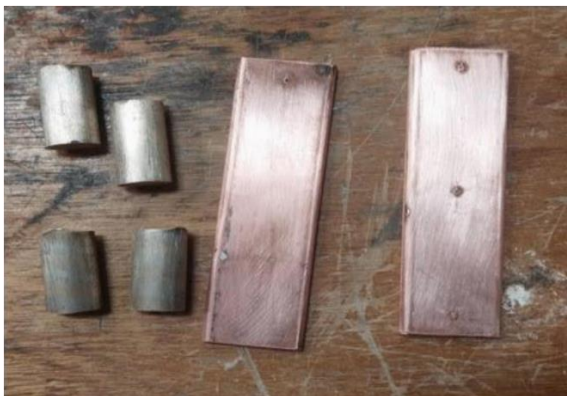
Figure 3.16 : cuivre coupé des cathodes et du support et le jeu de barres
