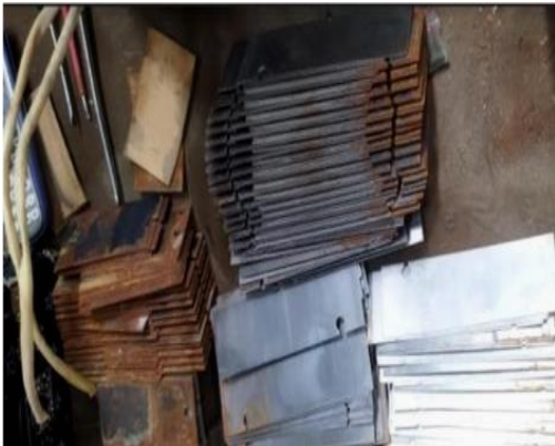
Figure 3.4 : nettoyage des lames du circuit magnétique
