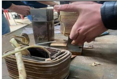
Figure3.3 : retrait des deux bobinages ( primaire et secondaire)
