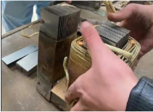
Figure3.3 : retrait des deux bobinages ( primaire et secondaire)
