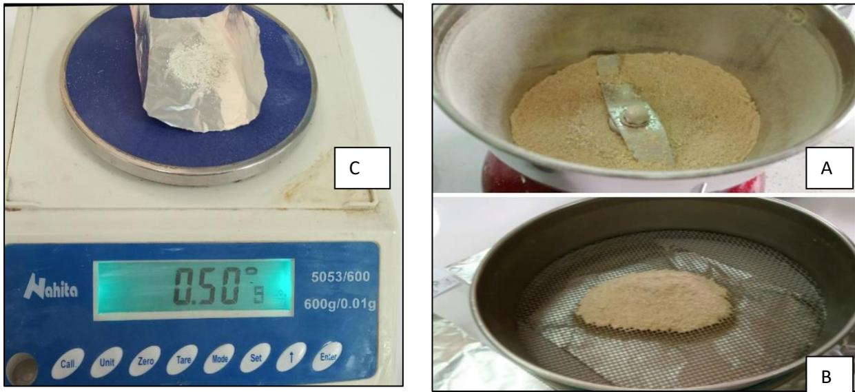
**Figure 5 :** Etapes a) broyage des graines b) tamisage des graines c) poids 0 ,50g
