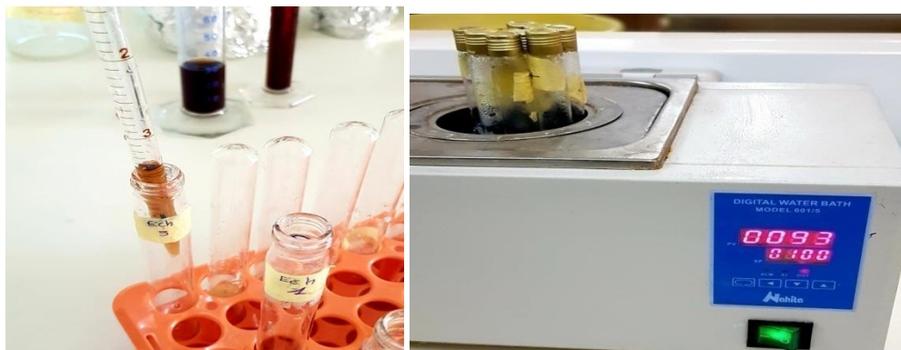
Figure 17 Préparation des tubes à essai pour être placés dans un bain-marie bouillant.
