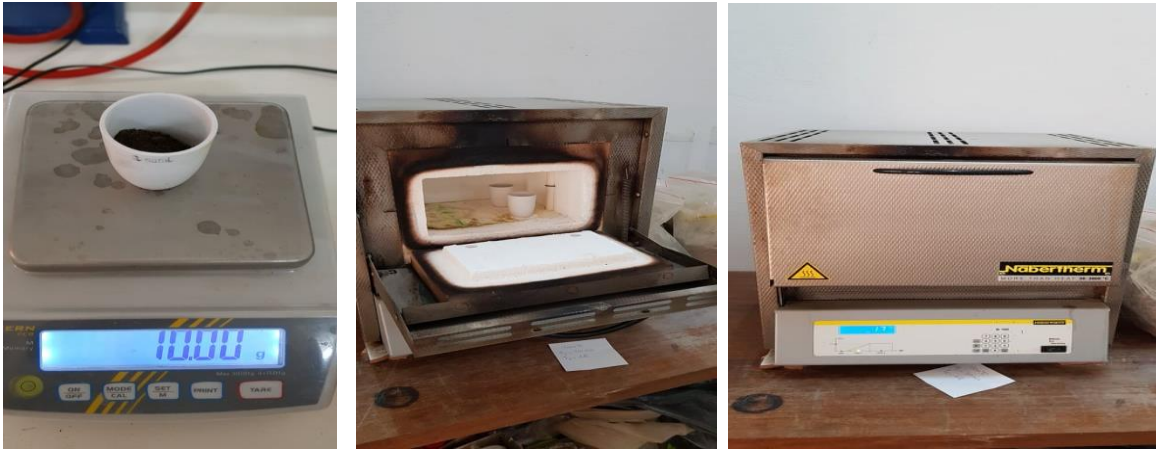
Figure 9 Le four a moufle qui réalise la calcination.
