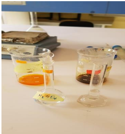
Figure 8 Mesure dans la matière organique de la méthode de Walkley et Black.
