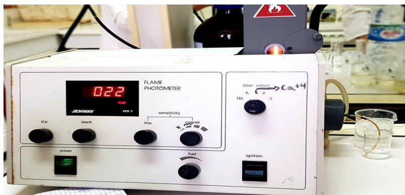
Figure 16 Dosage de Potassium du compost par un Photomètre à Flamme.
