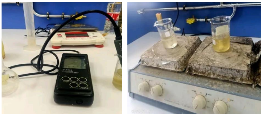
Figure 23 : Mesure de la conductivité électrique du miel naturel (originale, 2022)
