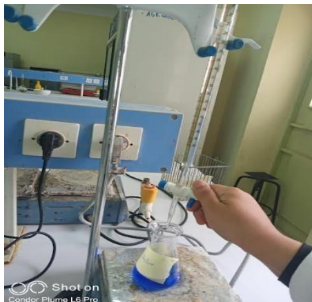
Figure 29 : l'opération de Titrage à blanc (blank titration) ( originale, 2022 )
