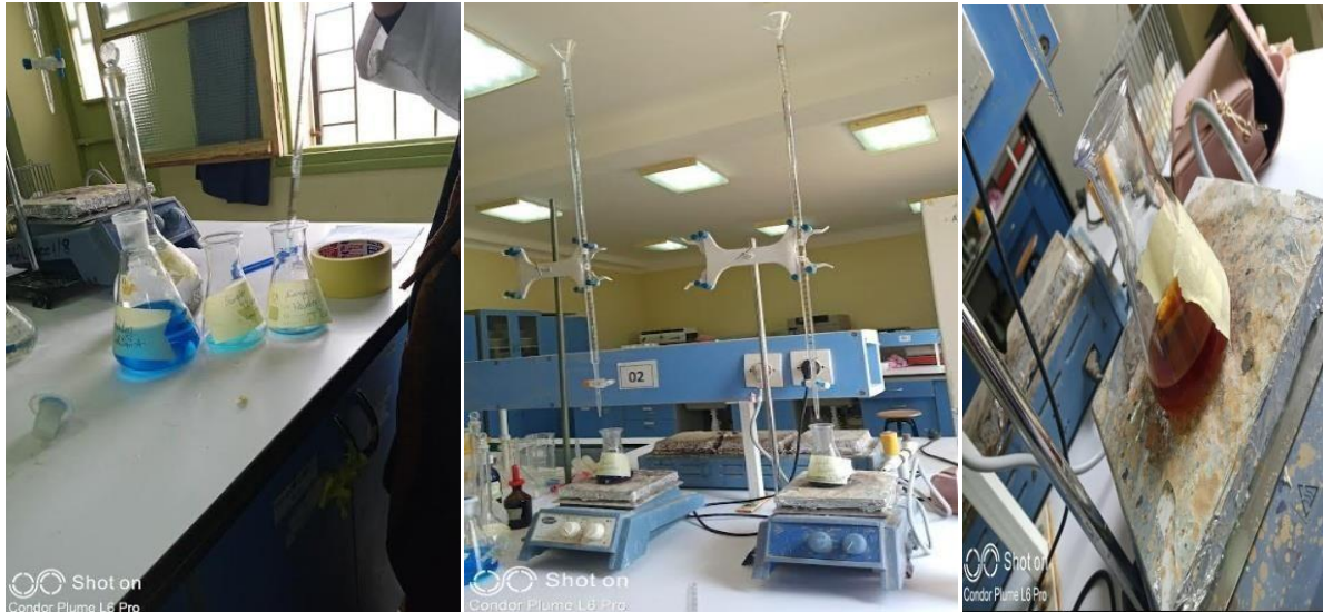
Figure 30 : l'opération de Titrage de l'échantillons ( sample titration) (originale,2022)
