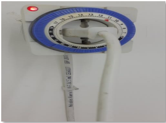
Figure 18: Le système de photopériode (16h/ 8h).
