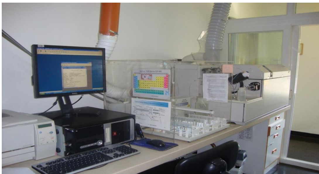
Figure 5: Présentation de l'ICP-MS7500( Nait merzoug et merazig, 2014).
