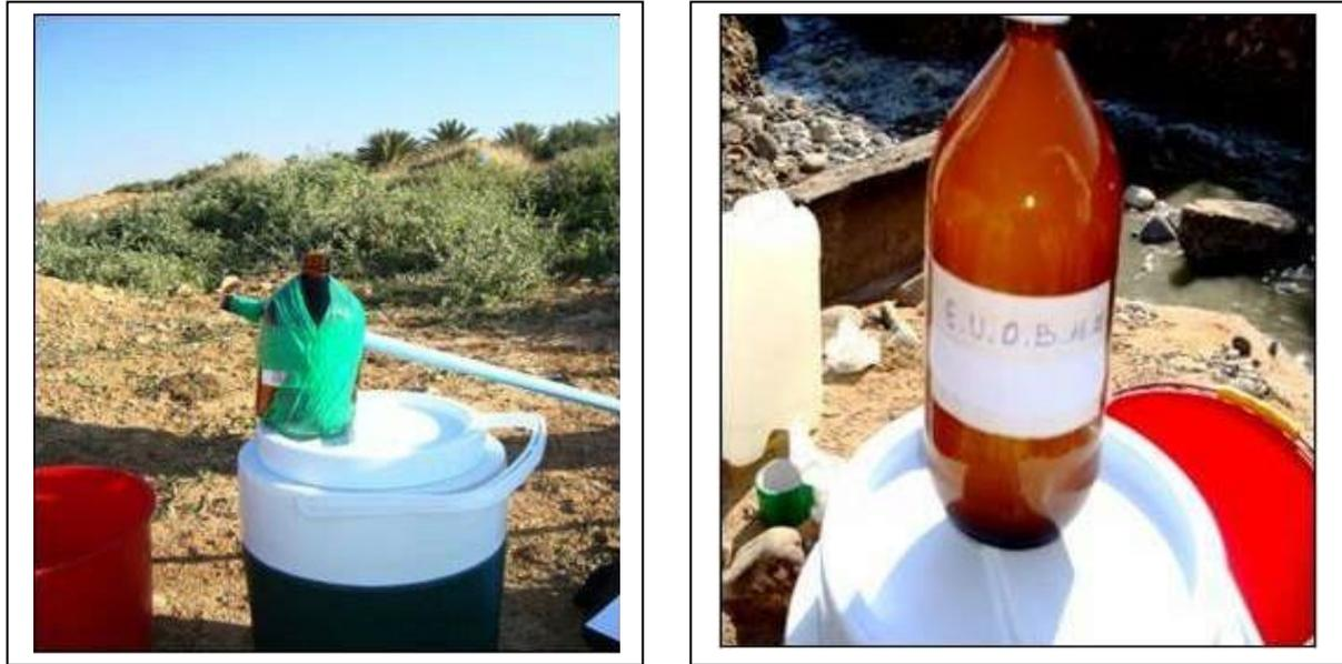
**Figure 2.11 :** L'échantillonnage et la conservation des eaux usées.
