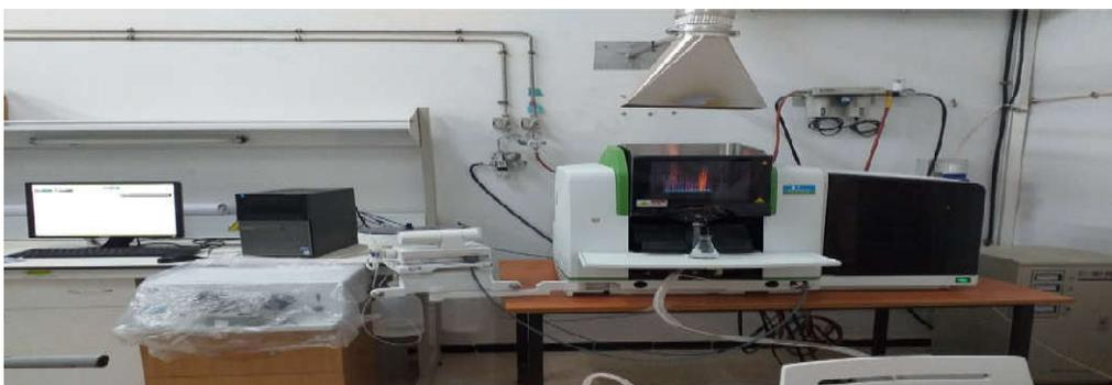
**Figure 8:** Spectromètre d'absorption atomique à flamme (FAAS) (Photo original).
