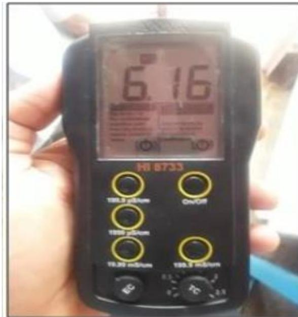
**Figure 03** : Mesure de la CE à l'aide d'un Conductimètre portable (la marque « Hanna », référence HI 8733) (BENSADEK,2019)
