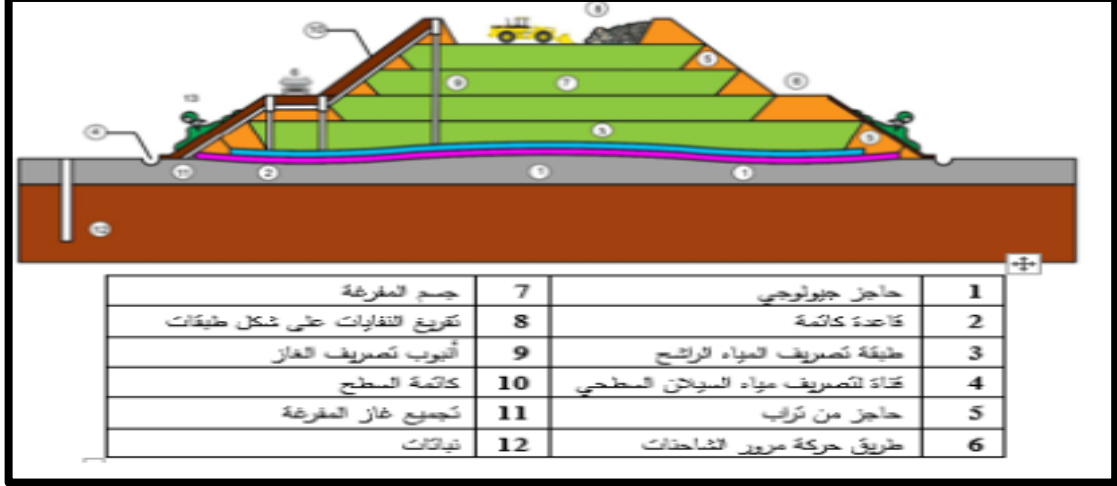
الشكل رقم (10): بنية مركز الردم التقني المصدر 28
