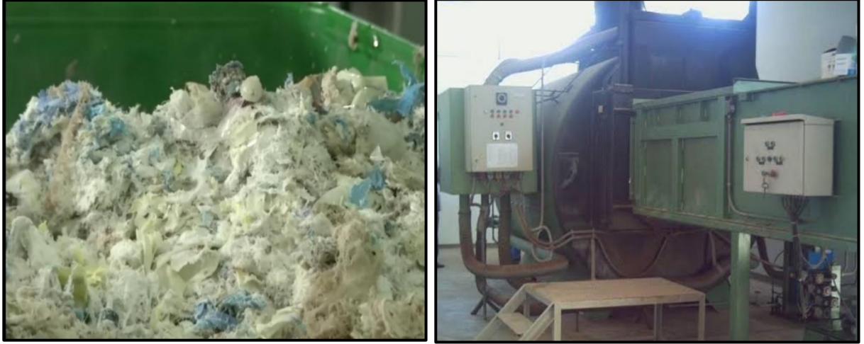
الشكل رقم (34) :آلة الفرغ والتعقيم المعدية "ايكوداس" المصدر :التقاط الطالبة
