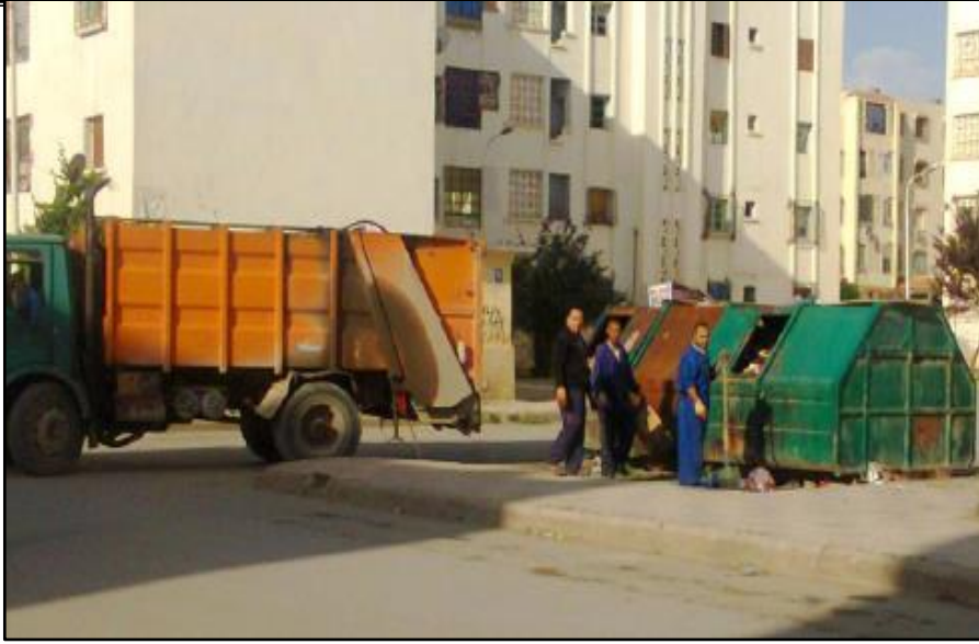
الشكل رقم(64): جمع النفايات المنزلية من حاوية حديدية بواسطة شاحنة أوتوماتيكية ضاغطة. المصدر: التقاط الطالبة
