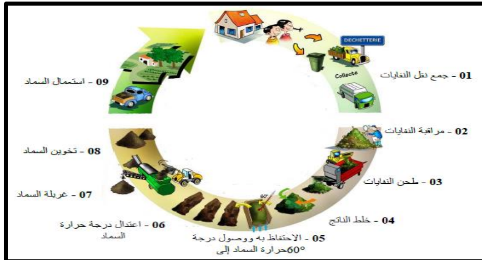
الشكل رقم (08) : مراحل المعالجة عن طريق التسميد المصدر 25
