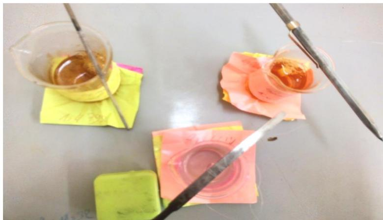
الشكل II-4 - التركيب التجريبي لتقنية الكتلة الضائعة في وجود وغياب المثبط.
