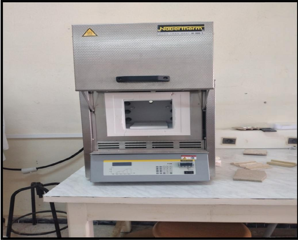
الشكل (II. 9): صورة لفرن الكهربائي
