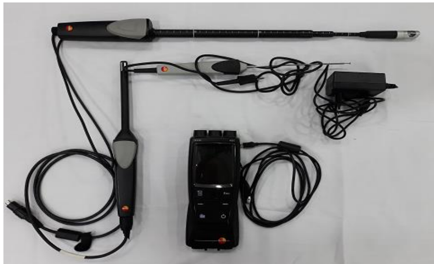
Figure VI.26 : Présentation des instruments de mesure - Testo 480- (Source : Auteur, 2020)
