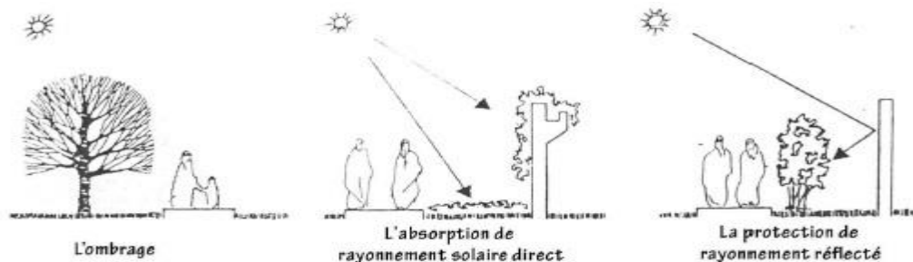
Fig. n° 11 : L'utilisation de la végétation pour diminuer l'effet de rayonnement solaire. Source : R. Ibrahim, 1984.
