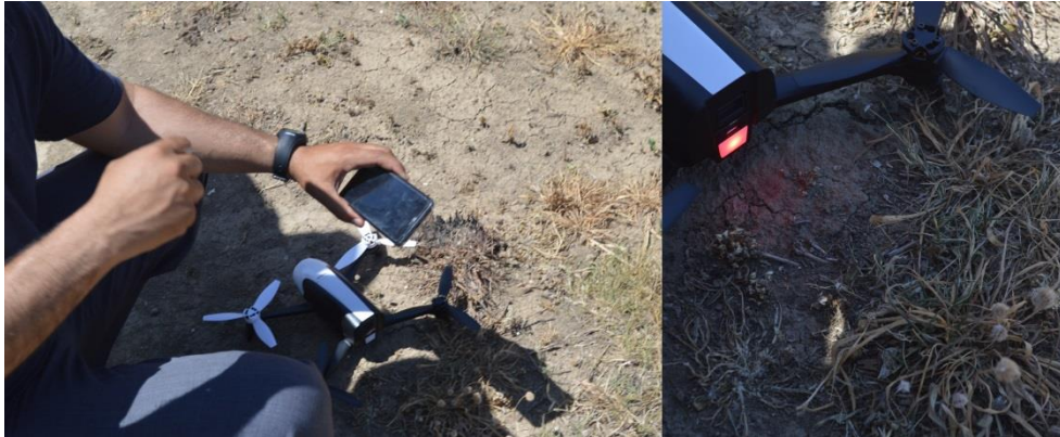
Figure 104 : Le drone Parrot bepop2, lieu d'atterrissage et lampe LED de repérage. Source : auteur.
