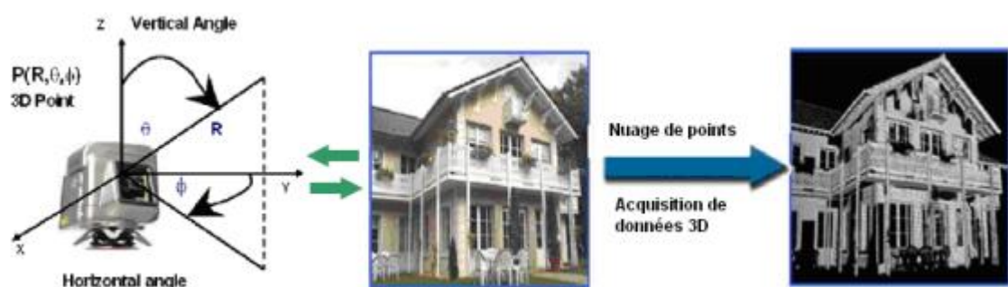
Figure 21 : acquisition de données par laser source : Yoo, H-J, 2011
