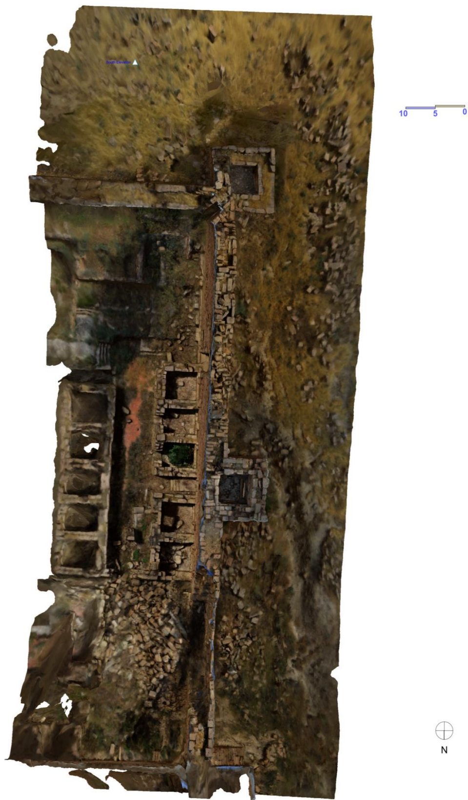
Figure 87 : le plan de la muraille ouest généré par agisoft photoscan.
