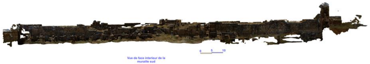
Figure 94 : vue de face intérieur de la muraille sud produits par Agisoft photoscan
