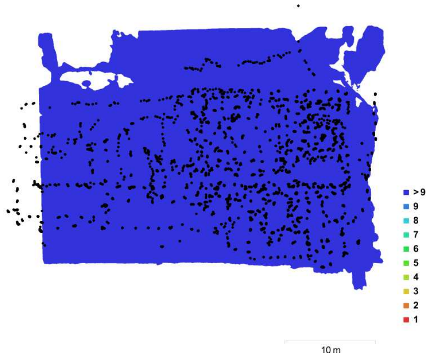
Figure 50 : emplacements et couverture d'images dans le modèle de la chapelle : emplacements des caméras (points) et chevauchement d'image (couleurs).
