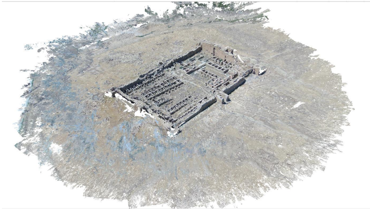
Figure 109 : nuage de points dense généré par pix4Dmapper.
