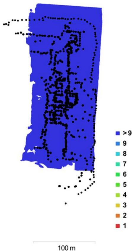
Figure 85 : emplacements et couvremet d'images dans le modèle 3D de Mur ouest rue ouest : Emplacements des caméras (points) et chevauchement d'image (couleurs).
