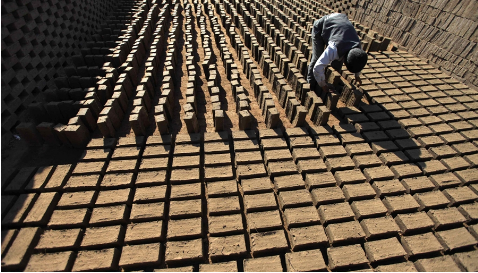
Figure II- 6. Séchage des adobes. Source : (Al-sayaghi, 2012)
