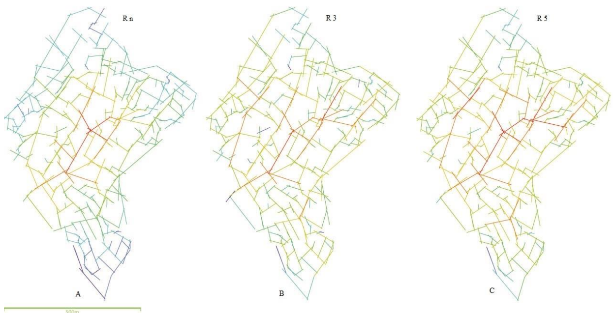
Figure 6-5: Cartes axiales (fewest lines minimal), paramètre d'intégration topologique (Rn, R3, R5) Constantine 1838. Source : Auteur
