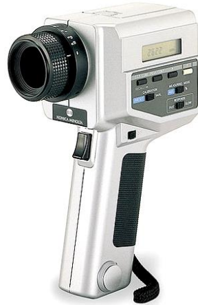
Figure.5.5 : Le Luminance-mètre (appareil de mesure de la luminance) (Source : www.directindustry.fr ).
