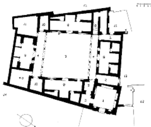
Figure.2.5 : Irrégularité de la forme en raison des configurations de rues (maison de la médina du Tunis) (Source : Programme MED).
