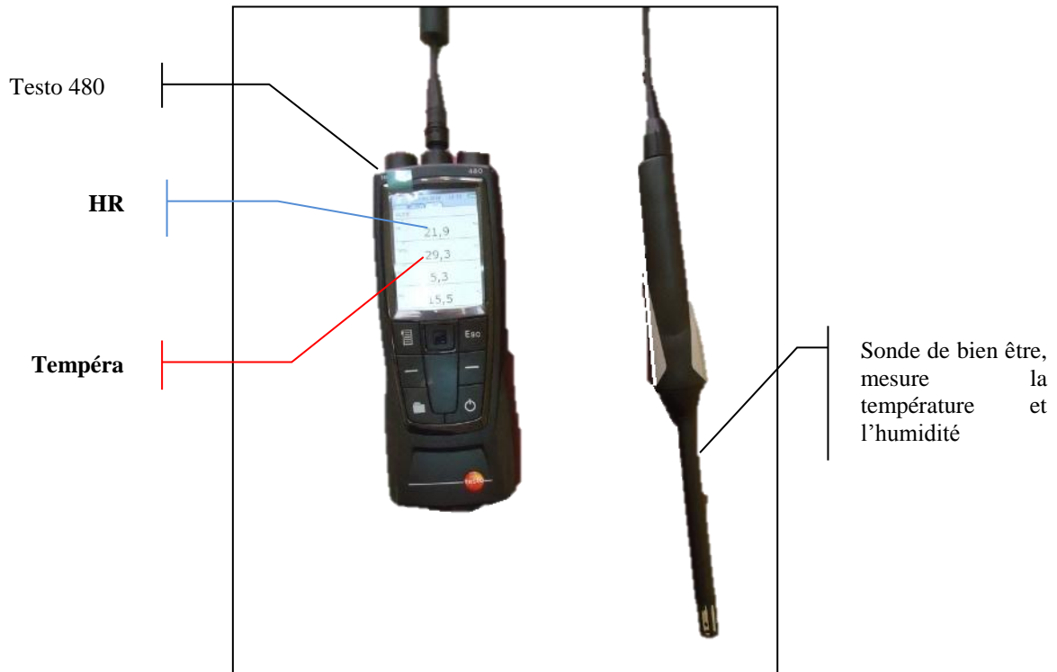
Figure III.42: le Testo 480 pour la mesure de la température et de l'humidité relative (Source : Auteur).
