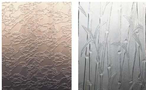
Figure II.8: exemple des verres imprimés. (Source : CSTC-Bruxelles, 1999)
