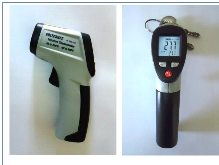
Figure III.43: Thermomètre à infrarouge (VOLTCRAFT), pour la mesure de la température de surface (source : auteur).
