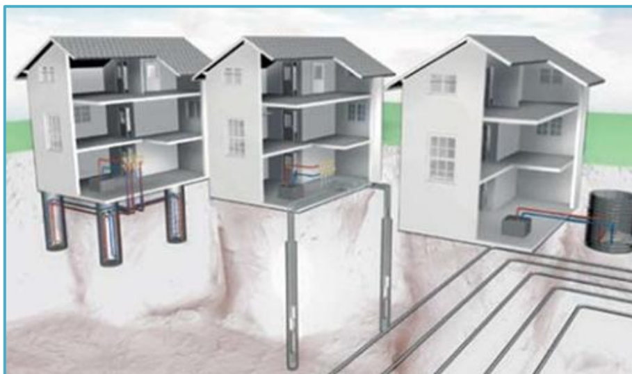
Fig.II.22 : types d'échangeur géothermique : les pieux, les sondes et les nappes.
