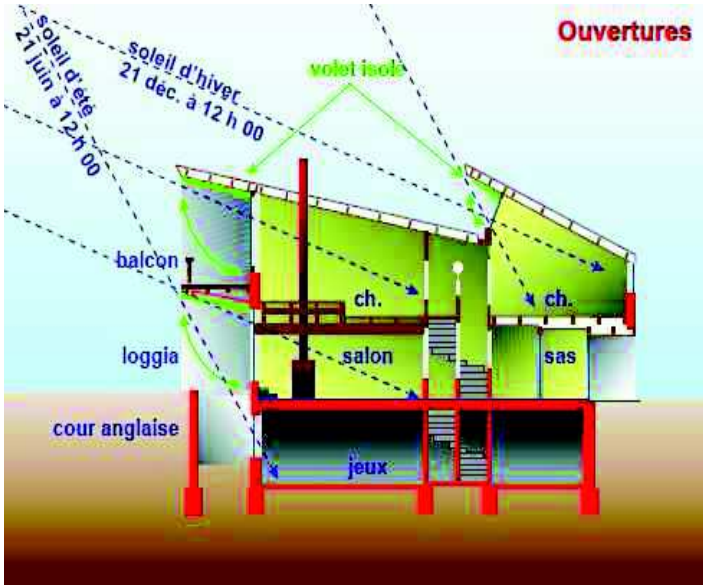
صورة 11.3 . استغلال الأشعة الشمسية شتاءً ، والحماية منها صيفا بحلول معمارية. المصدر : (Liebard, A et autre.2005)
