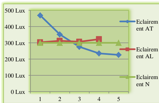
GrapheVI.11: Variation d'éclairage moyen dans la salle de classe N°02 à 9h le 21 Mars 2015. Source : Auteur.
