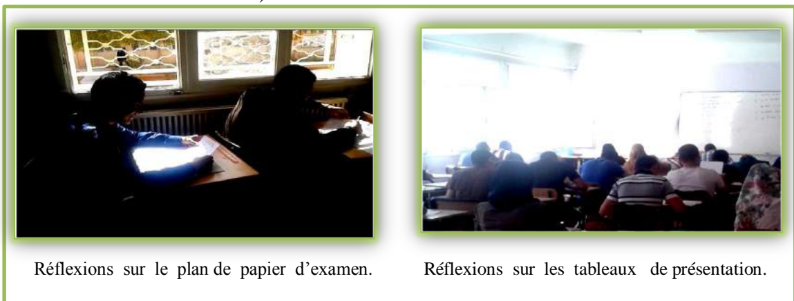
Figure III.11 : Cas d'éblouissement indirect dans une salle de classe de l'université de Laghouat. Source : Auteur.
