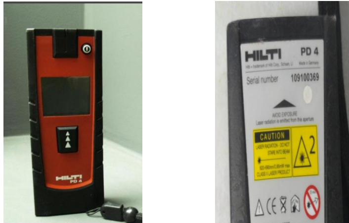
Figure IV-25: Laser mètre PD4 HILTI (Source : l'auteur)
