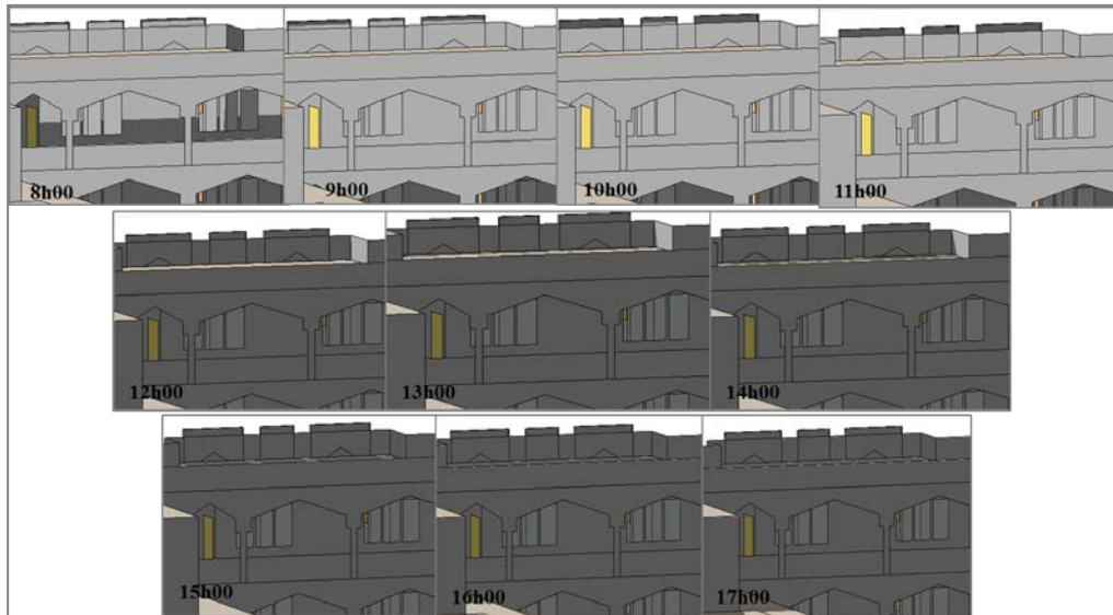
Fig VII. 16 : Ensoleillement de la façade Est de la salle de classe S1-4 (Source : Auteur)
