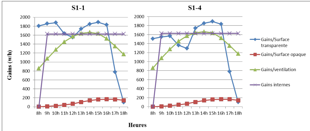
Fig VIII. 8 : Gains thermiques dans les salles de classe S1-1 et S1-4 (Source : Auteur)
