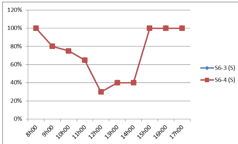
Fig VII. 2 : Facteur d'ombrage des façades Sud des salles de classe S6-3 et S6-4 (Source : Auteur)
