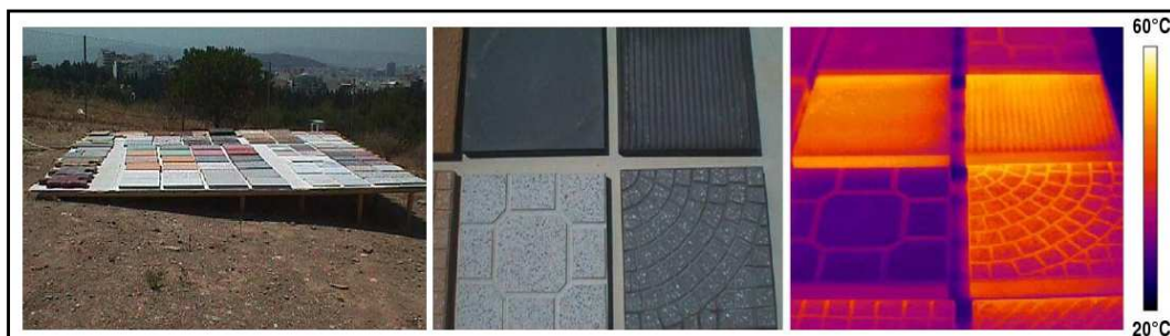
Fig. n°IV.8: Photo et thermographies IRT des revêtements testés dans l'étude de Doulos et al, 2004, source : Bouyer, J.2009.
