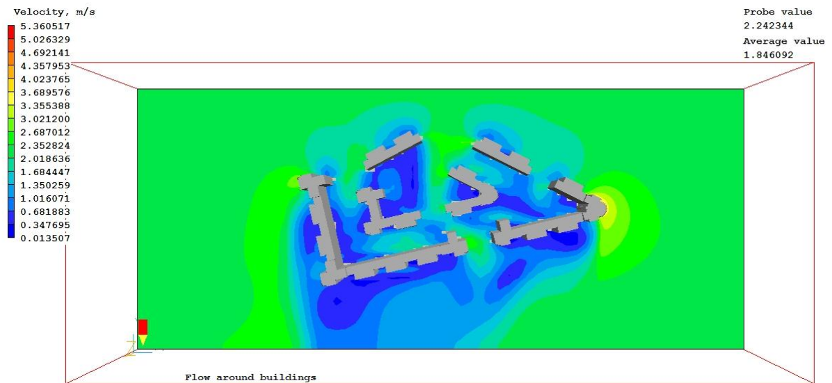
Fig. 95.2 – Vue en plan de l'écoulement du vent autour des bâtiments à 1.5 m au dessus du sol.
