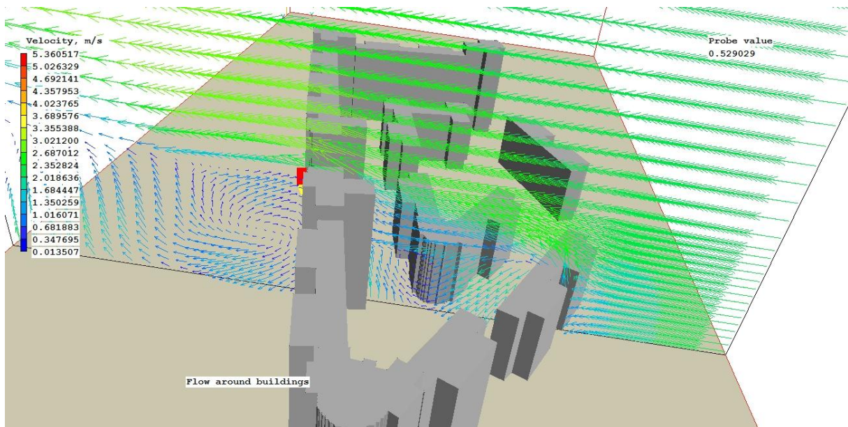
Fig. 95.13 – Représentation vectorielle des écoulements verticaux de la frontière EST de la cité.
