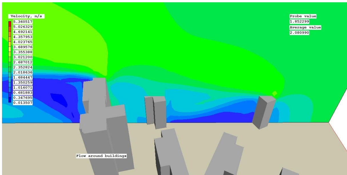
Fig. 95.16 – Vue verticale de l'écoulement de la frontière EST de la cité.
