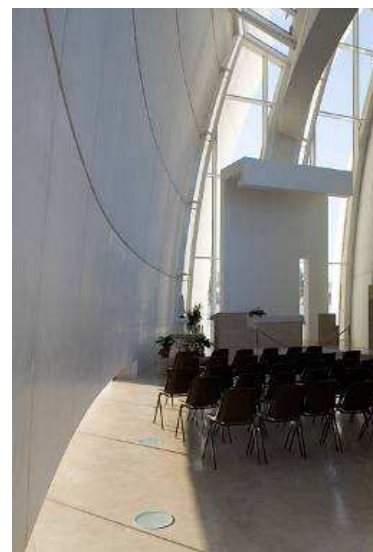
Figure 39 : Faite de béton, marbre et verre, l'église de Richard Meier célèbre la lumière naturelle dans le bâtiment. La lumière pénètre par le haut et par les découpes dans les murs latéraux.
