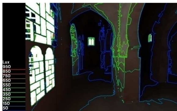
Figure 161 : Image montrant les courbes iso-lux
