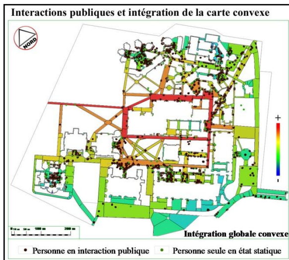
Fig. n°120 : Confrontation du schéma des interactions publiques avec les valeurs de l'intégration globale convexe. Source : auteur.
