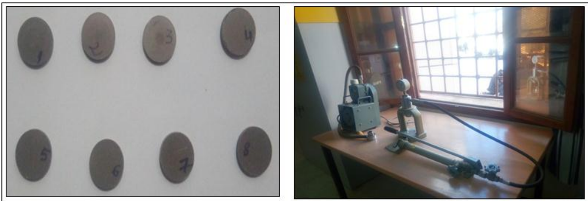
Figure II.16 : Transformation des échantillons poudre en échantillons comprimés
