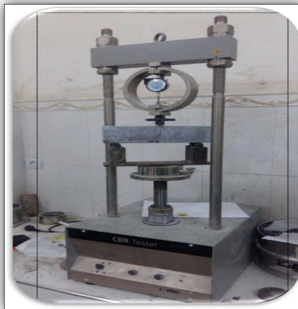
Figure II.7: presse CBR universelle pour flexion trois points pour éprouvettes prismatiques de bétons (70 x 70 x280 mm).
