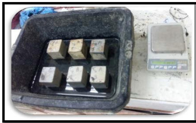
Figure II.9: Photo de l'essai d'absorption par capillarité
