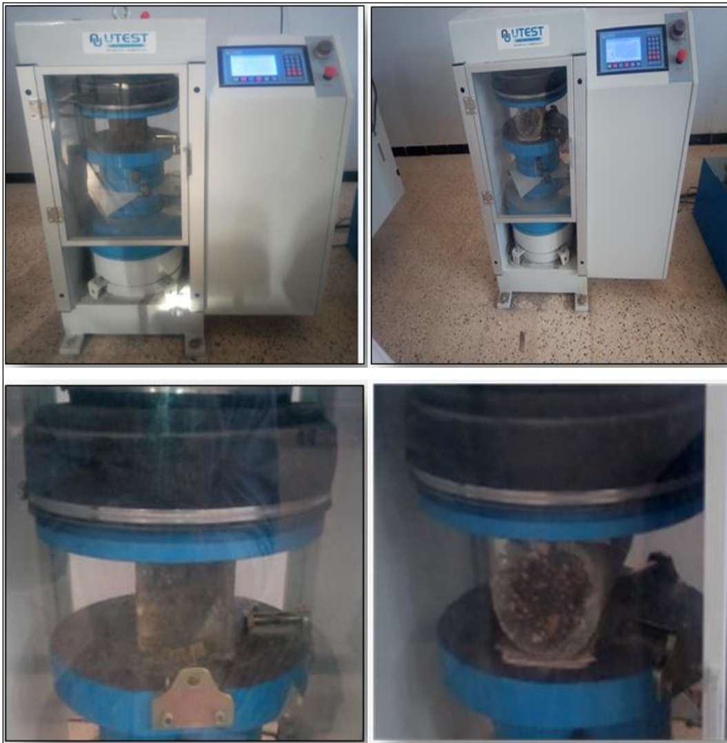
Figure II.5 : Essais de la compression et de traction par fendage
