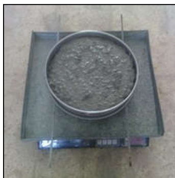
Photo 4.10 : Déroulement de l'essai de la stabilité au tamis
