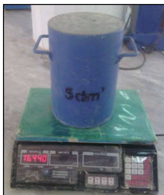
Photo 4.3 : Essai de la compacité des bétons frais
