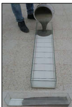
Photo 4.8 : Déroulement de l'essai de la boîte LCPC
