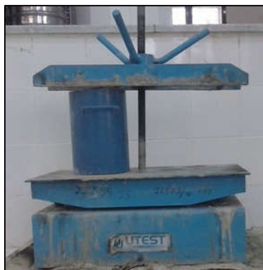
Photo 4.2 : Essai de la compacité serrée des granulats (graviers et sables)
