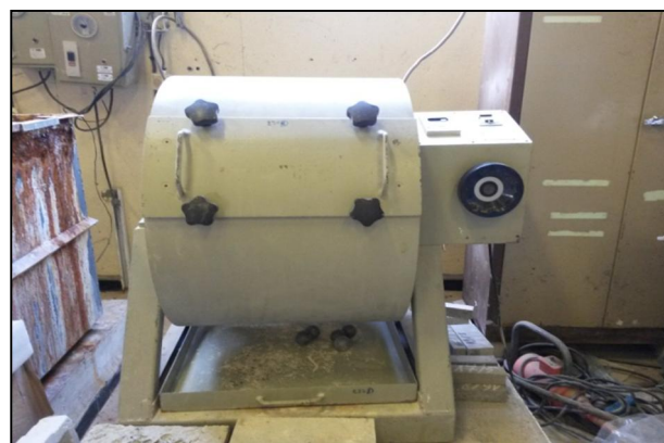
Figure III.8 : Appareil de Los Angeles (Laboratoire de GC de l'Université de Biskra)
