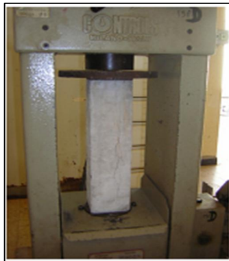
Figure III. 26: Essai de déformabilité : compression sur prisme de 10x10x40 cm
