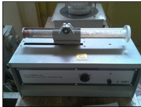
Figure III.7 : dispositif employé pour le calcul de l'équivalent de sable
