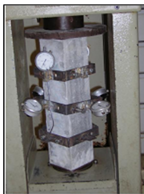
Figure III.27: Essai de déformabilité : mesure des déformations pendant la compression du prisme de 10x10x40 cm
