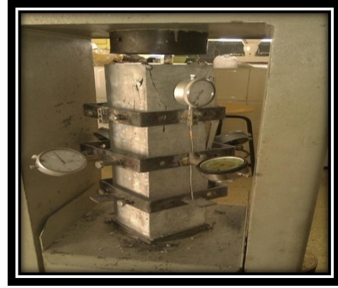
Figure IV.31: Essai de déformabilité
