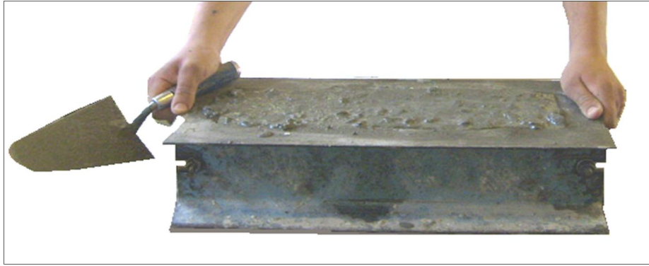
Figure III.20 : La confection d'éprouvette prismatique
