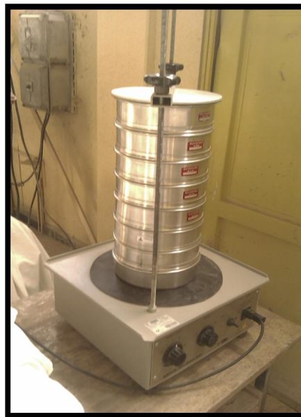
Figure III.5 : Procédure de tamisage (Laboratoire de GC de l'Université de Biskra)
