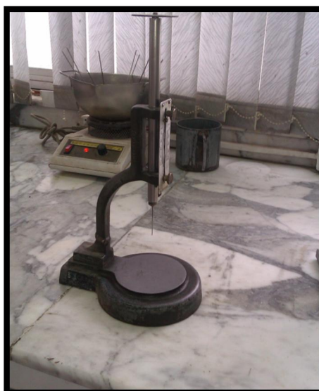
Figure III.2 : Dispositif employé pour le calcul de la consistance, du temps de prise (Vicat)
