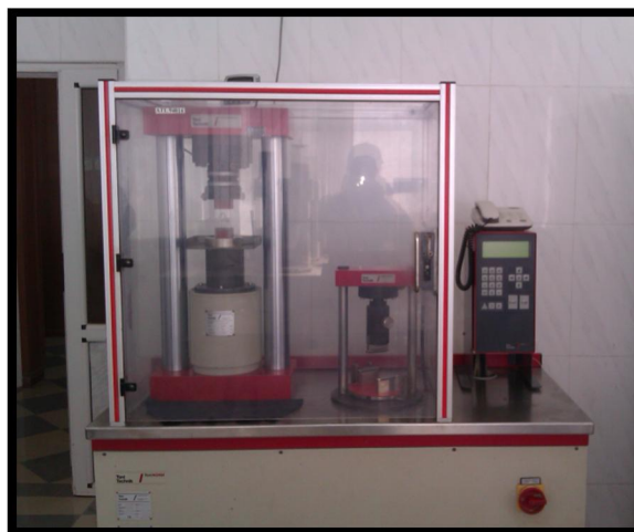
Figure III.4 : dispositif employé pour le calcul la résistance à la traction, à la compression et à la flexion du ciment
