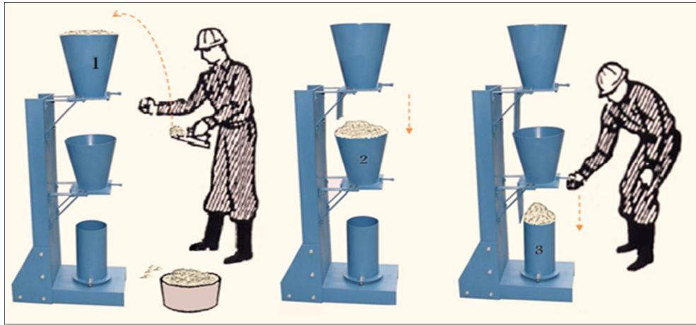
Figure III.15 : Schéma récapitulatif de l'utilisation l'appareil Glanville
