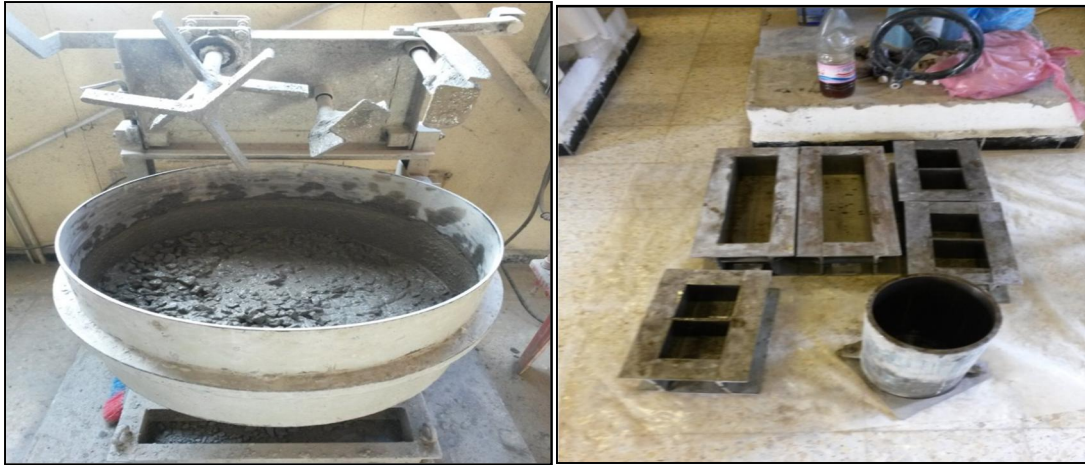
Figure III.11 : Malaxeur et moules utilisés pendant les essais
