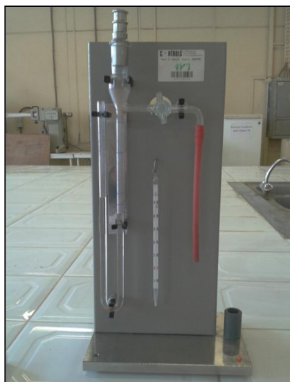
Figure III.3 : Dispositif employé pour le calcul de la finesse (Blaine)
