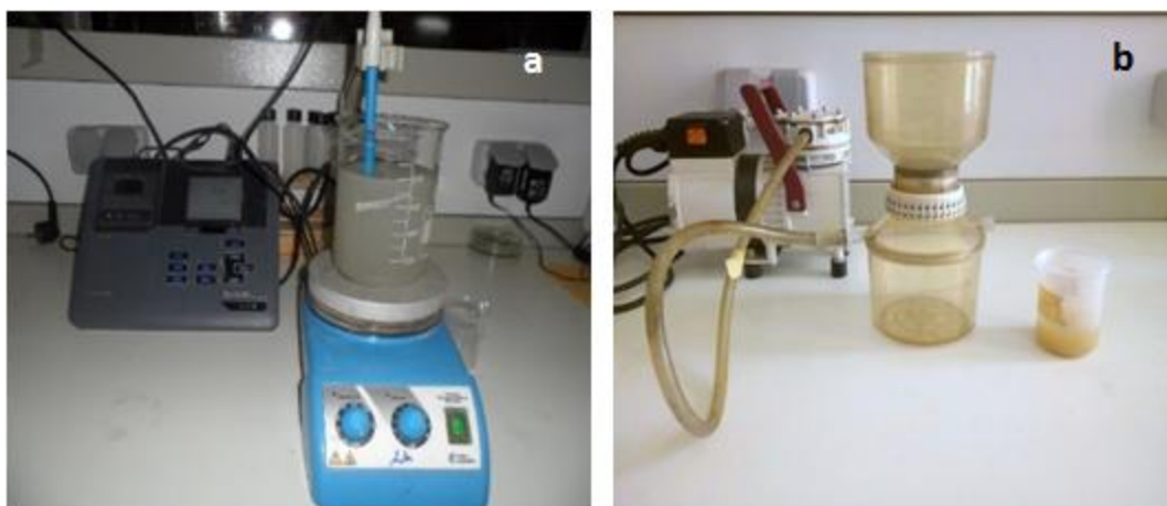
Figure 33 : Etapes des essais d'adsorption (a : agitation et b : filtration sous vide).
